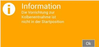
Ein Prozessstart ist erst möglich, wenn sich Haltestangen der Kolbenentnahmeverrichtung in ihrer jeweiligen Endlage befinden und der Warnhinweis auf dem Display mit [OK] bestätigt wurde!
