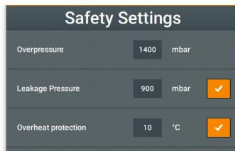
Le menu [Réglages de sécurité] permet de définir sous quelles conditions un processus en cours est automatiquement interrompu.
