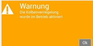
Ein Prozessstart ist erst möglich, wenn die Rotationsachse entriegelt und der Warnhinweis auf dem Display mit [OK] bestätigt wird!
