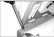
Dévissez deux vis Philips à la tôle de fixation du régulateur et enlevez le régulateur.
