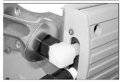
Dévissez avec une clé anglaise taille 17 l'écrou de raccord près de la vanne de lest d'air.
