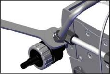
Dévissez avec une clé anglaise taille 17 l'écrou de raccord près de l'aspiration et détachez le tuyau.
