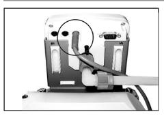
→ Détachez le câble de contrôle à l'arrière du régulateur. Ne pas coincer les connecteurs en les enlevant!
