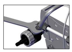
Positionnez le tuyau à la douille du raccord à l'aspiration. Vissez ensuite l'écrou de raccord tout d'abord à la main, puis donnez encore un tour avec la clé anglaise.
