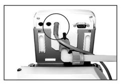
→ Connectez le câble de contrôle à l'arrière du régulateur. Ne pas coincer les connecteurs en les montant!
