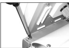
→ Assemblez le régulateur: Positionnez les deux vis Philips dans l'équerre de montage du régulateur et vissez-les dans les écrous se trouvant dans le couvercle de carter.
