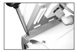
Dévissez deux vis Philips à la tôle de fixation du régulateur
