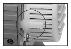
➡ Utilisez une clé anglaise et dévissez l'embout au refoulement de la pompe.
